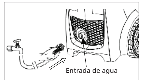
Figura 14 - Conecte la manguera de jardín a la unidad (sólo modelo PW1835)
